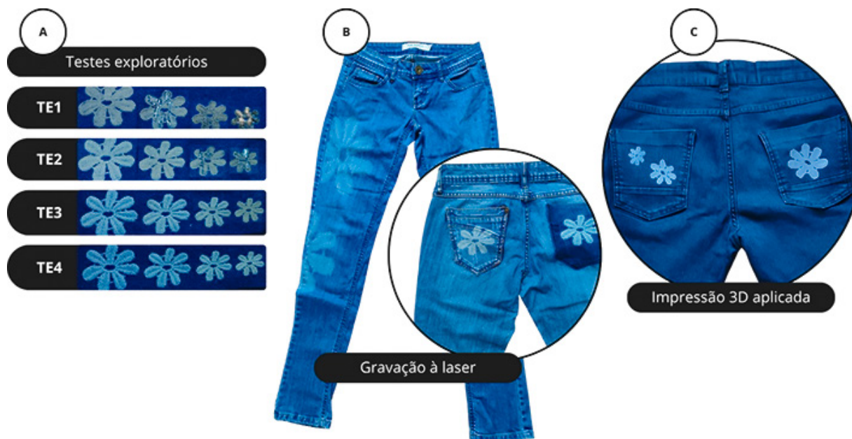
FIGURA 3: A) RESULTADOS DOS TESTES EXPLORATÓRIOS COM GRAVAÇÃO À LASER; B) GRAVAÇÕES FINAIS EM CALÇA JEANS; C) APLICAÇÃO DAS IMPRESSÕES 3D NA CALÇA JEANS.
