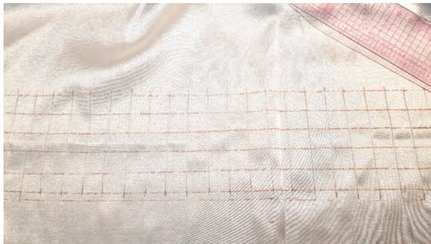
FIGURA 20 – PREPARAÇÃO PARA O BORDADO SMOCK , COM MARCAÇÃO FEITA NO PROTÓTIPO CONFECCIONADO
