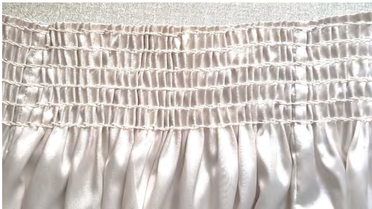
FIGURA 21 – FRANZIDO E BORDADO, EM PONTO SMOCK , FEITO NA LINHA DA CINTURA ALTA NO PROTÓTIPO DA SAIA-CALÇÃO
