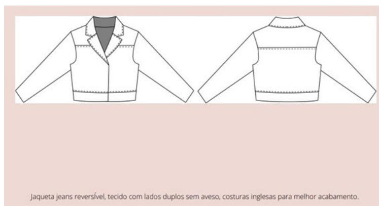
FIGURA 10 - DESENHO TÉCNICO DA JAQUETA FRENTE E VERSO.
